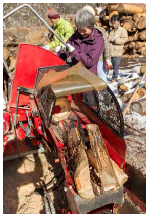
フィンランド製の自動薪割り機。原木のままセットし、レバーを下ろして付属のチェーンソーで玉切りすると、油圧ピストンが作動して十字の刃で4つ割にします。できた薪はそのままベルトコンベアで送り出されて、1カ所にたまります。
