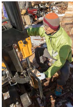
アメリカ製の手動薪割り機は、あらかじめ40センチに切っておいた丸太を台の上にセットし、レバーを操作して刃を上下させ、27トンの力で割って薪にします。
